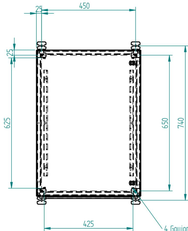
4 Goujons M8 x 25 pour fixation châssis
