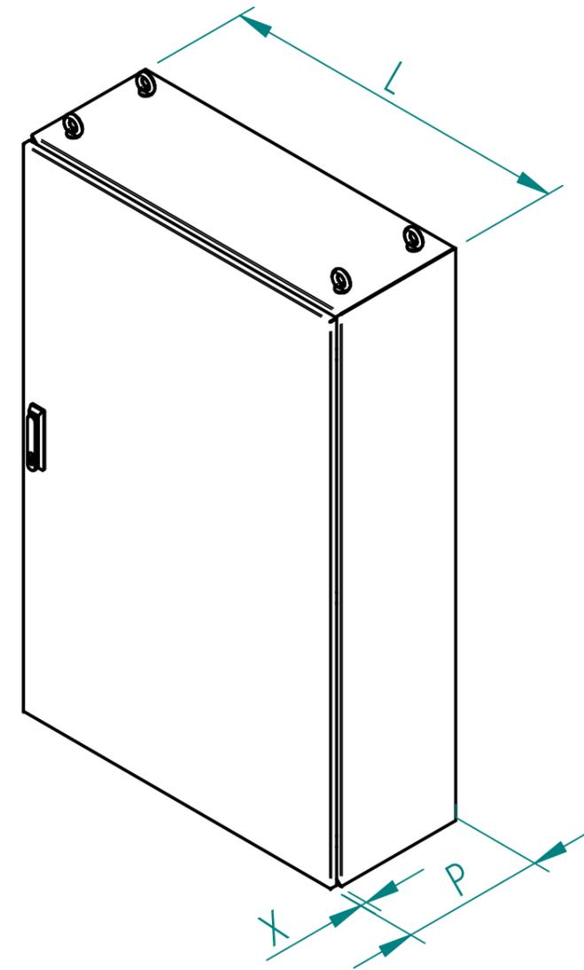
$X = \text{LARGEUR DE PORTE} + \text{JOINT} = 31 \text{ MM}$
